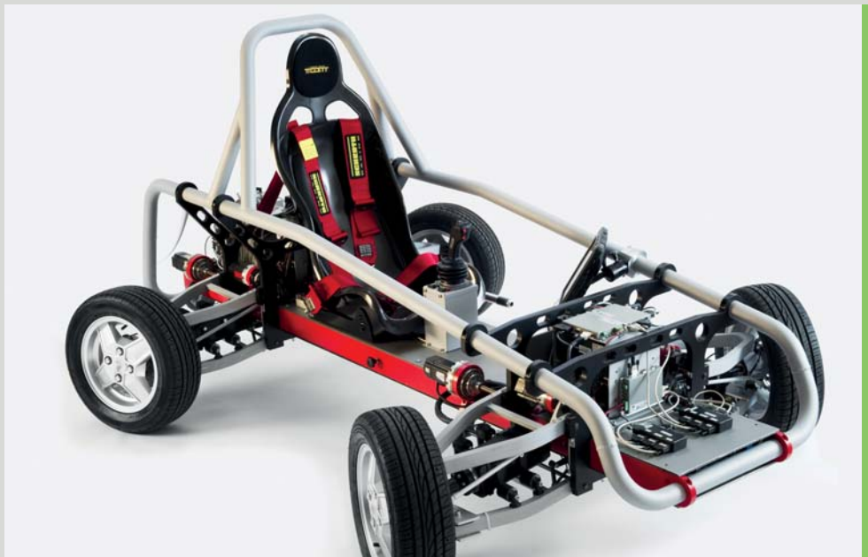
Innovative Mechatronik: das Chamäleon – Demonstrator eines intelligenten Elektrofahrzeugs mit x-by-wire-Technologie
