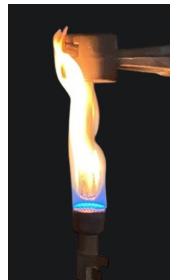
DURCHFÜHRUNG DER BRANDSCHUTZ- KLASSIFIZIERUNG NACH UL94-V STANDARD
