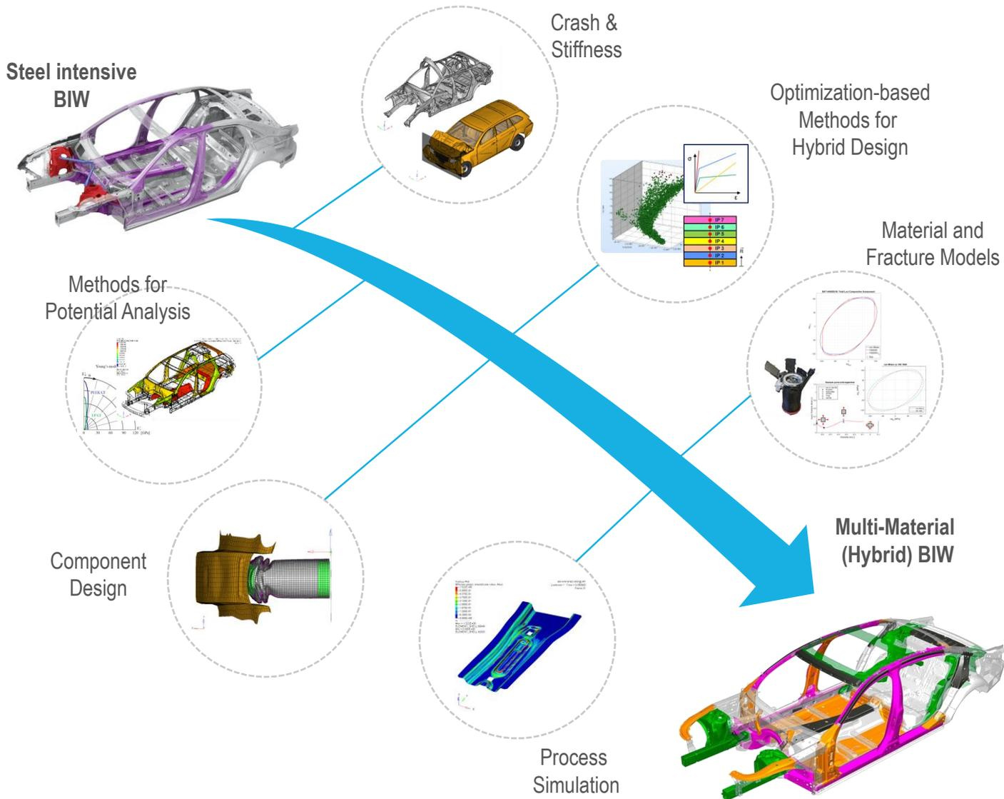
Im Team Simulation beschäftigen wir uns Schwerpunktmäßig mit der Methodenentwicklung zur Potentialfindung und Optimierung von hybriden Werkstoffverbunden. Ein besonderer Fokus liegt in der Materialmodellierung von Werkstoffen und deren experimentelle Kalibrierung. Die Materialmodelle werden beginnend von der Prozesssimulation bis hin zur Komponenten- und Gesamtfahrzeugsimulation benötigt.
