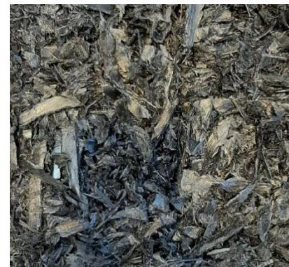
Ein innovativer Ansatz zur Wiederverwertung des Verschnitts besteht darin, das Material in sogenannte Flakes zu zerkleinern, gleichmäßig zu verteilen, über den Schmelzpunkt zu erhitzen und zu einem neuen Halbzeug zu verpressen. Dieser Ansatz verspricht ein neuartiges Laminat, das bei erhöhter Material- und Energieeffizienz in Anwendungen mit moderaten Anforderungen an das mechanische Eigenschaftsprofil eingesetzt werden kann.
