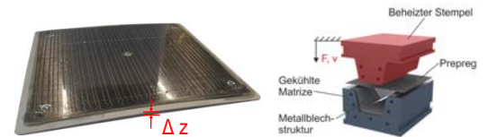
Thermisch induzierte Eigenspannungen (l.) und der Lösungsansatz (r.)
