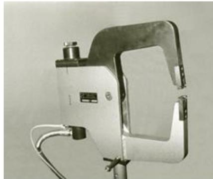
**Abb. 5.2.2: Erste Clinchzange der Firma Walter Eckold GmbH & Co. KG 1981**
