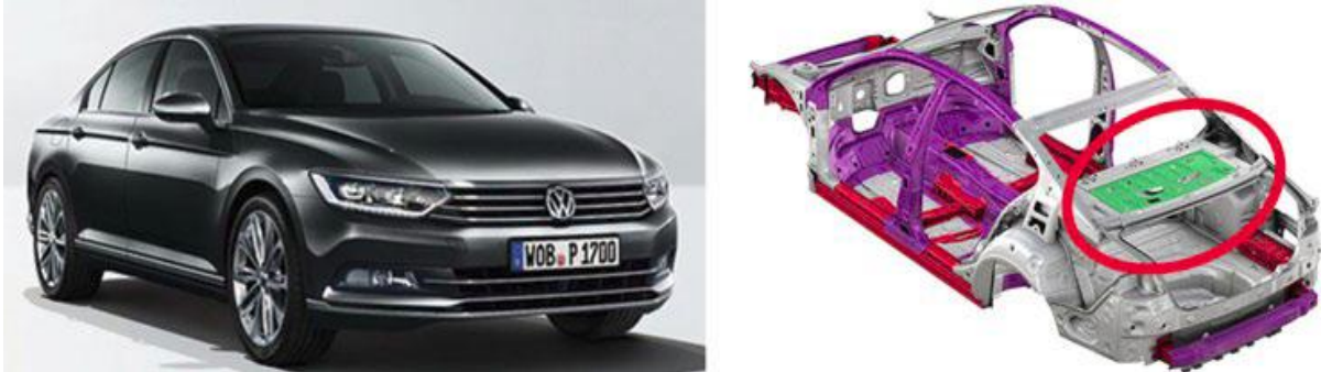
Abbildung 2-2: Mittels Widerstandselementschweißen gefügte Hutablage im Volkswagen Passat B8 (Quelle: Volkswagen)
