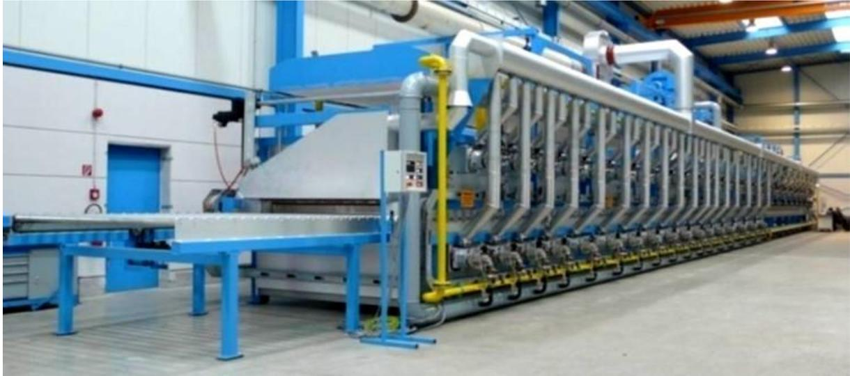
Abbildung 2-3: Rollenherdofen für das Presshärten (Hersteller: Schwartz GmbH, Simmerath) [Zei13]
