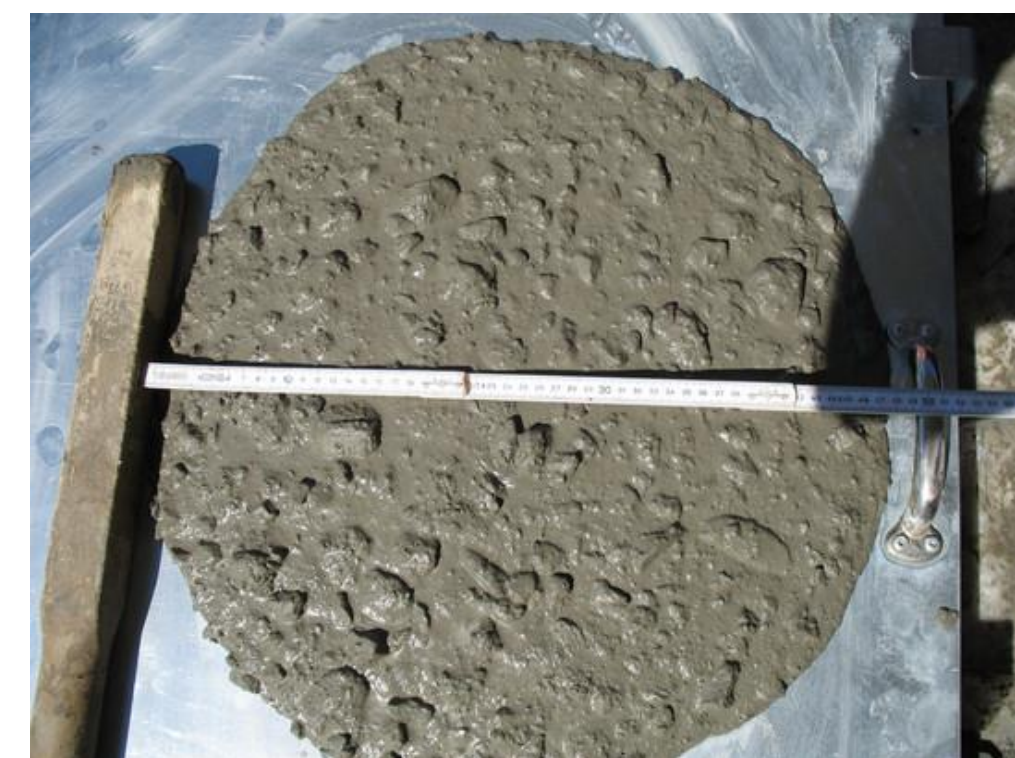
Ausbreitversuch zur Prüfung der Konsistenz [https://www.gpl-ag.ch/pruefungen/links-pruefungen/fbk.html]
